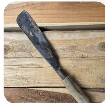
Bendho atau Golok Memotong, menyerut dan membelah bambu.
