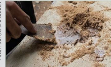
Menutup lubang (mendempul) dengan campuran serbuk kayu dan lem.
